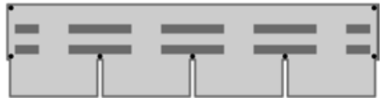
Рис. 12 Схемы расположения гвоздей.
