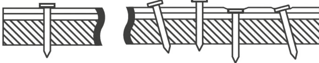
Рис. 3 Пример правильной забивки гвоздей при монтаже продукции.
